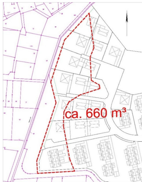
Abbildung 1: durch Höhenanpassung der Baugebietsfläche entfallende Überflutungsvolumen
