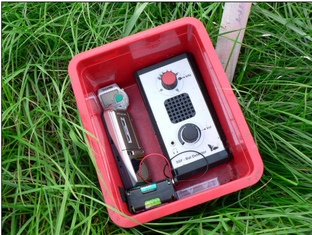
Abb. 1: Beispiel für den Aufbau einer Horchkiste
