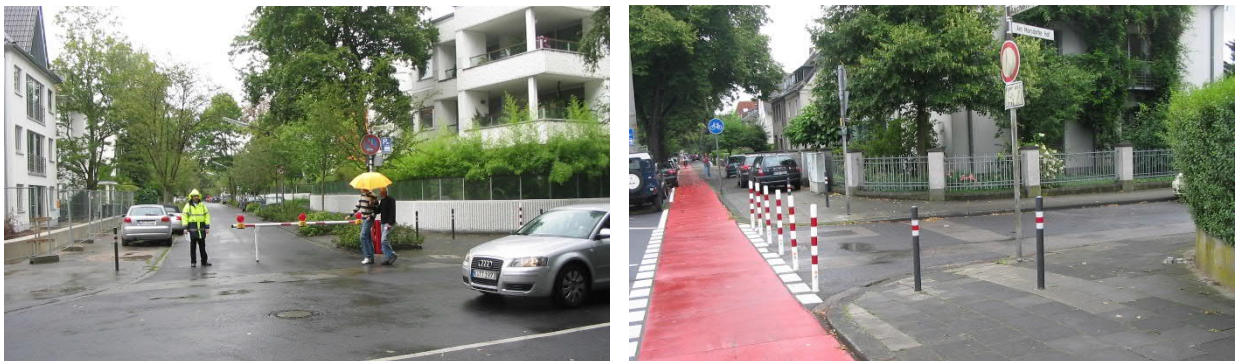
Abb. 4 Beispiele für Kontrollen eines Anwohnerschutzbereiches (links: manuell bediente Ausfahrtschranke, rechts: temporäre Absperungen durch Steckpfosten)
