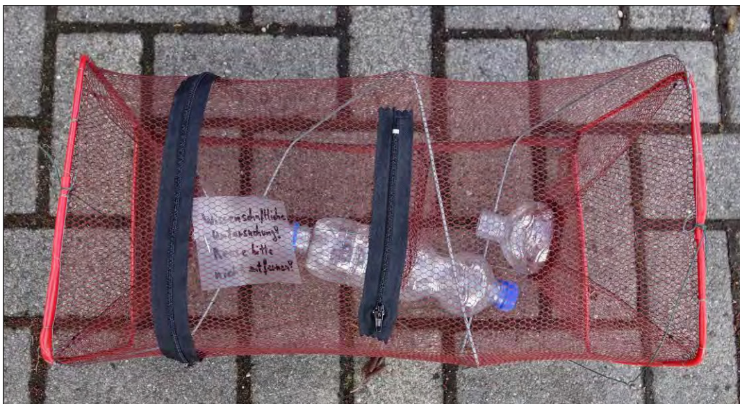
Abb. 1: Für den Nachweis von Molchen im Raum Heidbrook (Stadt Oldenburg) eingesetzte, vom Verf. modifizierte Kleinfischreuse. Die in der Reuse befindliche PET-Flasche dient als Auftriebskörper, so dass es den Tieren möglich ist, atmosphärischen Sauerstoff aufzunehmen.
